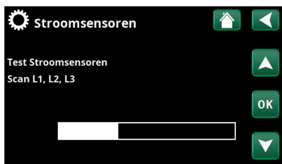
Menu: "Installateur/Instellingen/Stroomsensoren /Auto config. stroomsensor".
